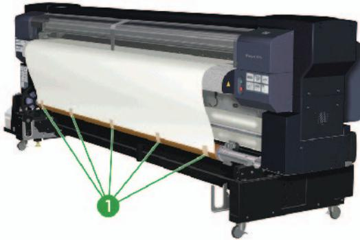
12. Überprüfen Sie, ob sich die Spannstangenführung (1) im Empfangsbereich des Sensors (2) befindet. Passen Sie die Position ggf. an.
