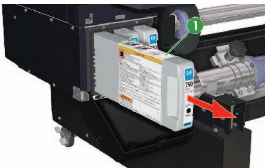
3. Setzen Sie eine neue Tintenpatrone (1) in den Drucker ein.
