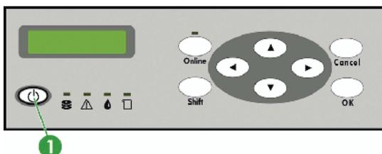
4. Wenn Sie die **Netztaste** drücken, führt der Drucker einen Selbsttest durch und gibt folgende Meldungen auf dem Bedienfeld aus.
