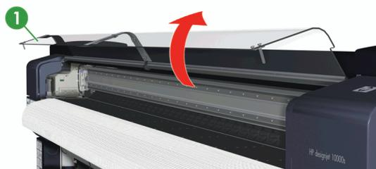
7. Schieben Sie die Medienkantenführungen (1) bis zu den Enden der Druckplatte nach außen, damit sie nicht vom Medium verdeckt werden.
