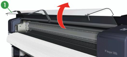
13. Schieben Sie die Medienkantenführungen (1) bis zu den Enden der Druckplatte nach außen, damit sie nicht vom Medium verdeckt werden.
