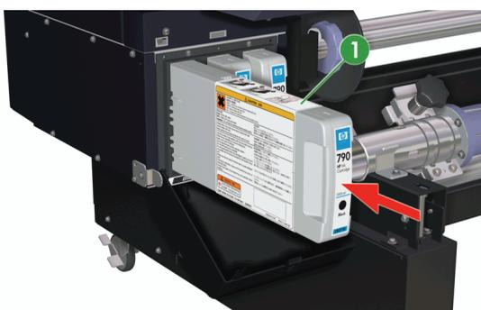
4. Schließen Sie die Tintenpatronenklappe (1).
