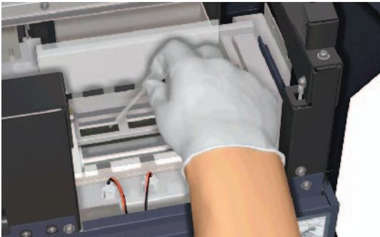
11. Befeuchten Sie auch beide Enden des Schwamms (1) unter dem Riemen (2).
