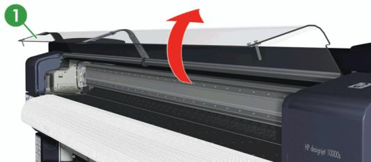
7. Öffnen Sie die Abdeckung (1) der Kapselungseinheit.
