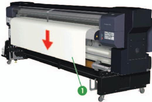
11. Befestigen Sie das Medium an der Kernhülle auf dem Hauptwickler (Aufwickelvorrichtung).
