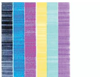
Wenn es in allen Farben zu Streifenbildung kommt, müssen Sie den Drucker für die geladenen Medien kalibrieren. Wenn Sie einen vordefinierten Medientyp verwenden, sollten Sie nicht dessen Einstellungen ändern, sondern einen neuen Medientyp erstellen (siehe [Erstellen eines neuen Medientyps](#)) und danach den Drucker kalibrieren (siehe [Kalibrieren des Druckers](#)). Die Streifenbildung kann in Form weißer Linien (wie in der Abbildung oben) oder in Form dunklerer Linien auftreten.
