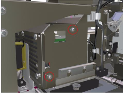
從印字頭冷卻風扇組件中取出螺絲時請多加小心，因為螺絲很容易落入印表機內。
