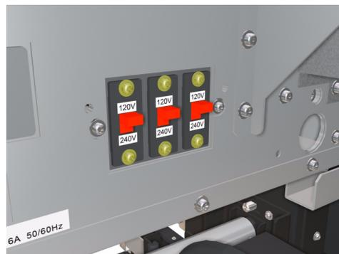
4. 正確更換電壓設定板 (1) 以使選定的電壓顯示在外部。
