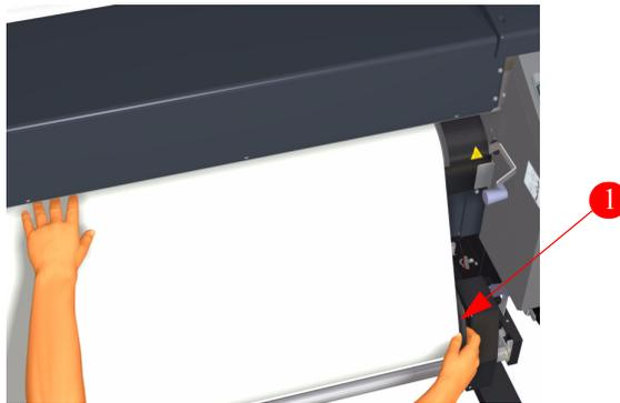
12. 打開後蓋，然後調整材質邊緣擋板 (1)。
