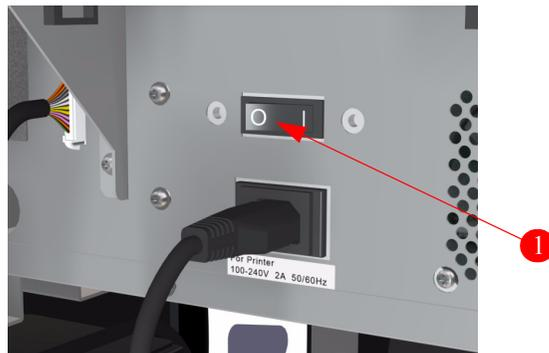
4. 確定印表機背面的加熱器電源開關 (1) 位於關閉位置，然後再連接加熱器電源線 (2)。
