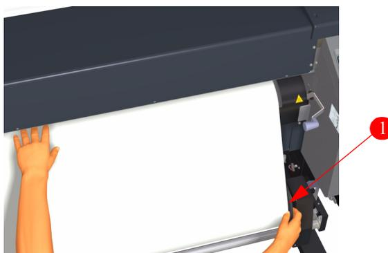
**12** Ouvrez le couvercle arrière et réglez les guides de largeur du support (1).
