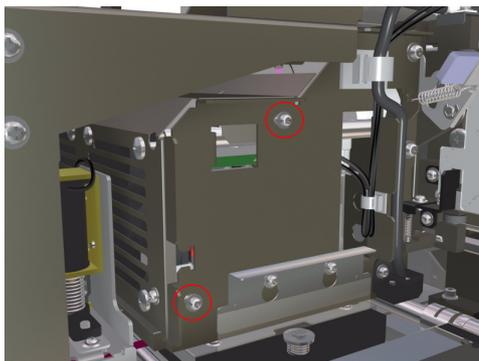
**Tome cuidado ao remover os parafusos da Montagem de ventoinhas de refrigeração dos cabeçotes, pois eles podem cair facilmente dentro da impressora.**
