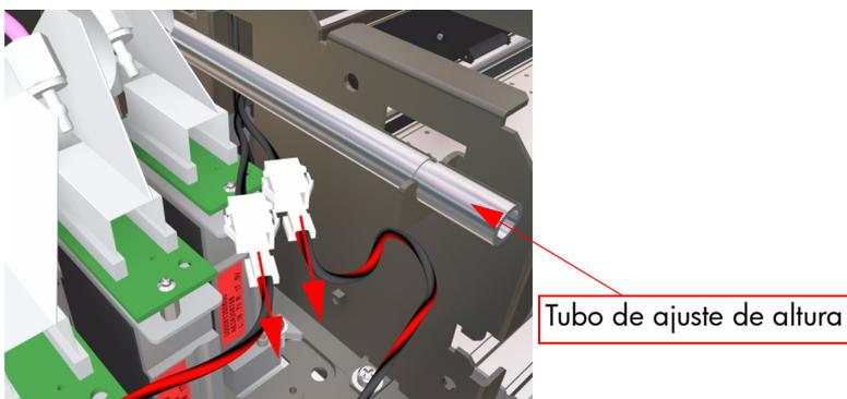
**Compruebe que los tubos y el ajuste de altura de los cabezales están situados correctamente, en especial cuando coloque de nuevo las cubiertas.**
