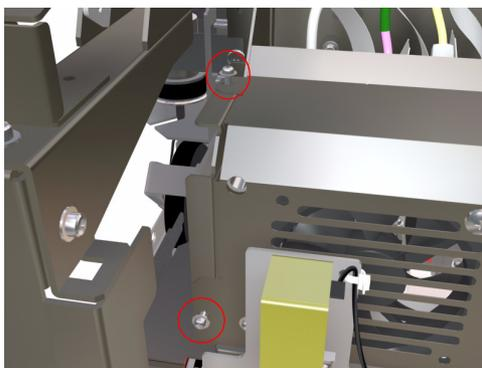
**Tenga mucho cuidado al sacar los tornillos del conjunto del ventilador de refrigeración de los cabezales porque podrían caer en el interior de la impresora.**
