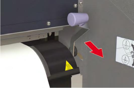
14. 打开后盖并调整介质边缘挡板和风扇防护手柄的位置。
