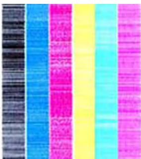
如果看到所有颜色都有条带，则需要针对所装的介质校准打印机。如果选择了预设的介质类型，则建议您在修改设置前先创建一种新介质类型（请参阅“我如何...创建新介质类型”），然后再校准打印机。请参阅校准打印机。条带可能表现为白色线条（如上图）或更暗的线条。
