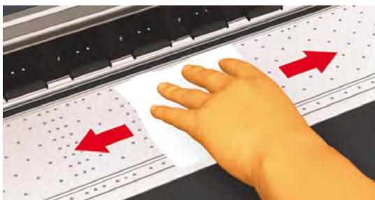
5. S'il y a des dépôts d'encre dans les orifices vides du cylindre, nettoyez-les à l'aide de cotons-tiges de 3 mm disponibles dans le commerce, puis essuyez les dépôts d'encre à l'aide d'un coton-tige légèrement humidifié avec de l'alcool.
