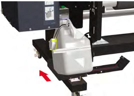
5. Abbassate la leva e inserite il tubo dell'inchiostro sulla vite nella bottiglia, quindi serrate la vite. Accertatevi che la bottiglia per l'inchiostro residuo sia posizionata saldamente.
