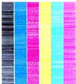
Se sono presenti bande in tutti i colori, è necessario calibrare la stampante per il supporto caricato. Se avete selezionato un tipo di supporto predefinito, si consiglia di creare un nuovo tipo di supporto prima di modificare le impostazioni (vedere Procedura passo passo... [Creazione di un nuovo tipo di supporto](#)), quindi calibrare la stampante. Vedere [Calibrazione della stampante](#). Le bande possono essere costituite da strisce bianche (come nella figura precedente) o da strisce nere.
