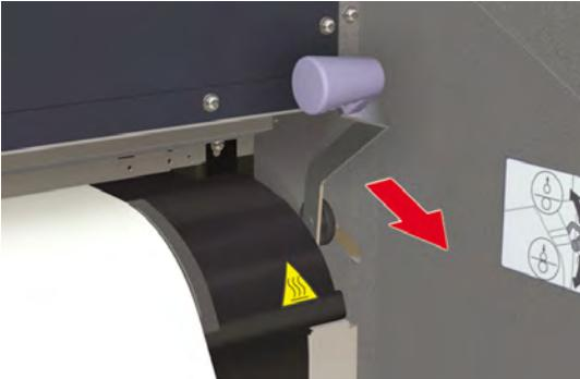
14. Öffnen Sie die hintere Abdeckung, stellen Sie die Medienkantenführungen ein, und passen Sie die Position des Lüfterführungshebels an.
