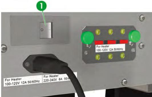
1. Netzschalter für Heizvorrichtungen
