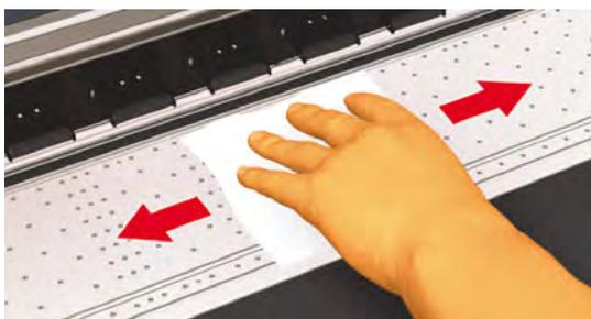
5. Wenn sich in den Öffnungen in der Platte Tintenrückstände befinden, lösen Sie diese mit einem handelsüblichen Wattestäbchen. Befeuchten Sie anschließend ein anderes Wattestäbchen leicht mit Alkohol, und entfernen Sie die gelösten Tintenrückstände.
