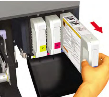
3. Setzen Sie die neue Tintenpatrone in den Drucker ein.
