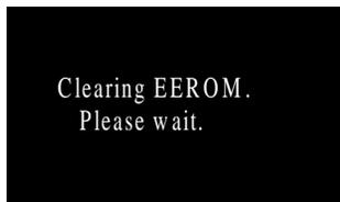
**ADVERTÊNCIA** NÃO DESLIGUE A IMPRESSORA ENQUANTO A EEROM ESTIVER SENDO APAGADA, POIS ISTO PODE DANIFICAR O MÓDULO ELETRÔNICO.
