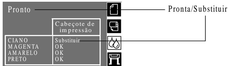
A impressora ainda poderá funcionar com um cabeçote que necessite ser substituído. O painel frontal irá exibir:
