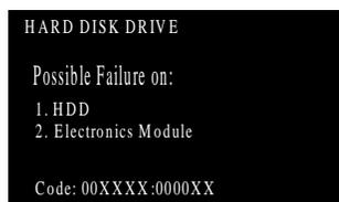
**NOTA** Verifique que el "Hard Disk Drive" esté correctamente instalado antes de iniciar el proceso de resolución de problemas. Si el "Hard Disk Drive" NO está instalado, la prueba siempre fallará.
