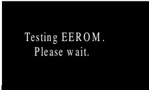
**ADVERTENCIA** NO APAGUE LA IMPRESORA MIENTRAS SE ESTÉ REALIZANDO LA PRUEBA. ESTO PODRÍA DAÑAR EL "ELECTRONICS MODULE".
